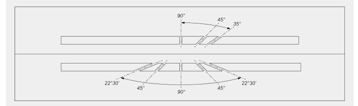
Regolazione elettronica delle angolazioni intermedie su asse verticale Regolazione meccanica delle angolazioni intermedie su asse orizzontale
