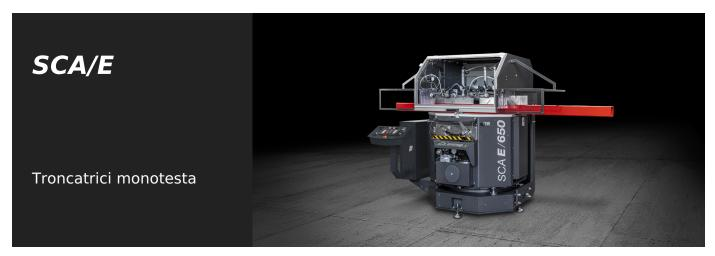
Troncatrice monotesta ascendente con rotazione automatica a CN dell'asse verticale mediante motore brushless e contemporaneo ribaltamento a comando idraulico dell'asse orizzontale. Tagli con angolazioni da 90° a 22°30′ (sinistra e destra) sull'asse verticale e da 90° a 35° (solo a destra) sull'asse orizzontale.
