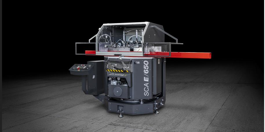
Troncatrice monotesta ascendente con rotazione automatica a CN dell'asse verticale mediante motore brushless e contemporaneo ribaltamento a comando idraulico dell'asse orizzontale. Tagli con angolazioni da 90° a 22°30' (sinistra e destra) sull'asse verticale e da 90° a 35° (solo a destra) sull'asse orizzontale.
