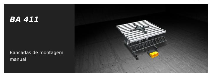
Bancada dedicada à ensamblagem do quadro de alumínio com a junta e o vidro. Mediante uma cruzeta o vidro é levantado e graças a um sistema de morsas com autoalinhamento os quadros são prensados dois a dois. Uma vez concluída a prensagem dos primeiros dois lados, faz-se girar a cruzeta e é possível prensar os outros dois lados.
