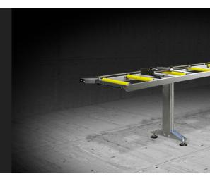
Estrutura em tubular de aço com pés ajustáveis e rolos de aço revestidos com PVC. Rolos de 240 mm., com comprimento da bancada de rolos de 3.500 mm., ou rolos de 440 mm. com comprimento da bancada de rolos de 4.000 mm.
