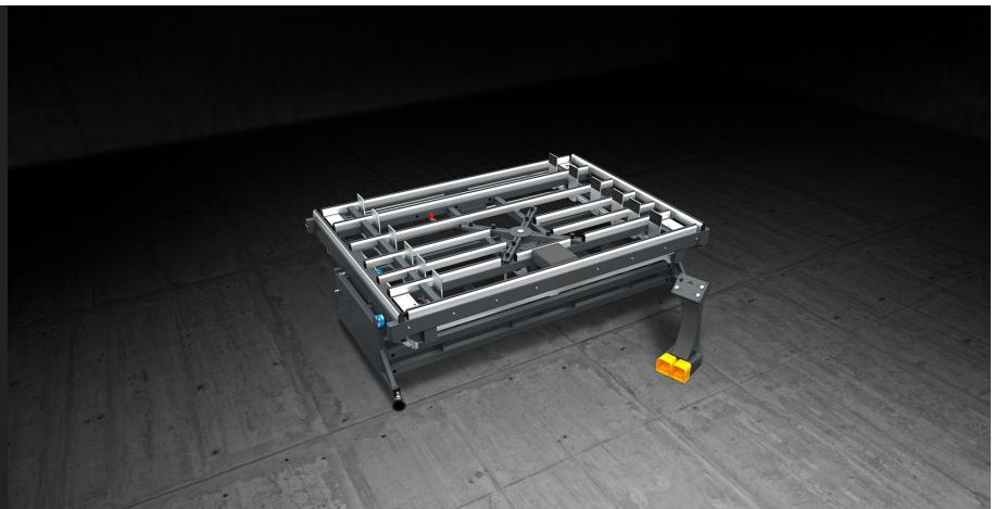
Bancada dedicada à ensamblagem do quadro de alumínio com a junta e o vidro. Mediante uma cruzeta o vidro é levantado e graças a um sistema de morsas com autoalinhamento os quadros são prensados dois a dois. Uma vez concluída a prensagem dos primeiros dois lados, faz-se girar a cruzeta e é possível prensar os outros dois lados.
