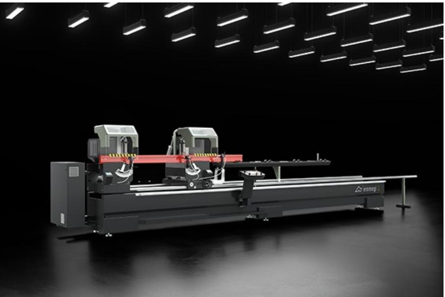
Máquina de corte eletrónica de cabeça dupla com movimento automático da cabeça móvel através de motor brushless comandado por um controlo numérico. Inclinação pneumática das unidades de corte em 3 posições fixas 90°, 45° e 22°30' (externa) ou com sistema mecânico de regulação manual dos ângulos intermediários. Avanço óleo-pneumático do disco de corte.
