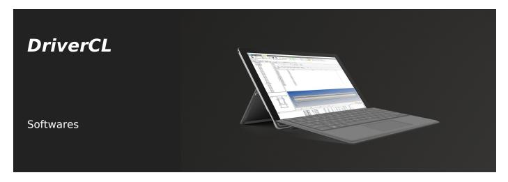
É o software que faz interface com o software para o fechamento, software de gestão e software CAD/CAM. Permite importar listas de trabalho (nos formatos "USTD" e "NCX") e dados inerentes a: ordem, perfil, peças, trabalhos (até 5 eixos), ferramentas, figuras livres, tornos. DriverCL, a conexão entre escritório-oficina é simplificada.
