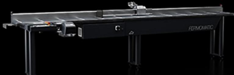
Sistema de comparação da medida e suporte do perfil com o movimento do bloqueio por meio do motor brushless e leitura eletrônica através de banda magnética absoluta. Disponível em três comprimentos, com alta precisão e repetibilidade de posicionamento.
