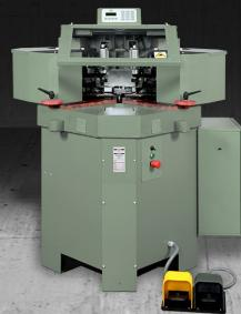
A máquina possui duas cabeças operadoras particulares equipadas com massas nas quais as 2 lâminas são reguláveis em todas as posições de chanfradura. As lâminas deslocam-se e são reguladas no eixo Y (ao longo do perfil), no eixo Z (alto-baixo) e no eixo X (ao longo da direção de chanfradura). Estas condições evitam a substituição das ferramentas na máquina, independentemente dos diferentes tipos de perfil. Desta forma, os tempos e os custos de colocação são reduzidos.
