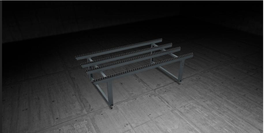
Plano de rolos, permite acoplar os postos de ensamblagem e transferir quadros, também muito pesados, com extrema facilidade.
