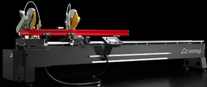
Máquina de corte de cabeça dupla com movimento manual da cabeça móvel e deteção da posição através de barra magnética absoluta. A rotação das unidades de corte no eixo vertical (45° para a esquerda e para a direita) e a inclinação no eixo horizontal (45° internos), com regulação manual, permitem cortes combinados também com ângulos intermediários.
