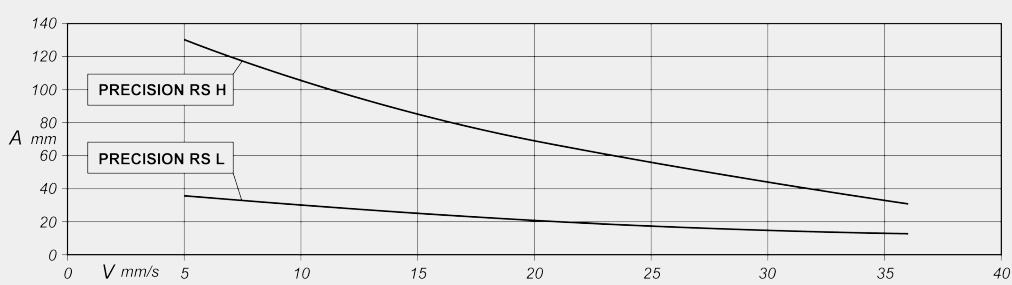
A = arco de contacto (mm)      V = velocidade de avanço da lâmina (mm/s)
