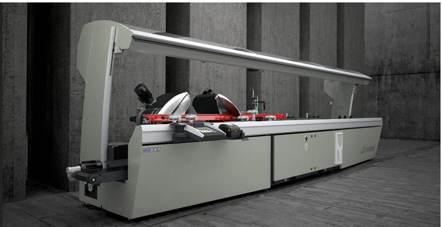
Máquina de corte com cabeça dupla de 3 eixos controlados para alumínio, PVC e ligas leves, com movimento automático da cabeça móvel e gestão eletrónica de todos os ângulos de 45° (internos) a 15° (externos), com uma precisão de 280 posições no interior de cada grau. Na versão base, o avanço do disco de corte é acionado por um par de cilindros óleo-pneumáticos. Disco de corte de 550 mm. Disponível com corte útil de 5 ou 6 m de comprimento.
