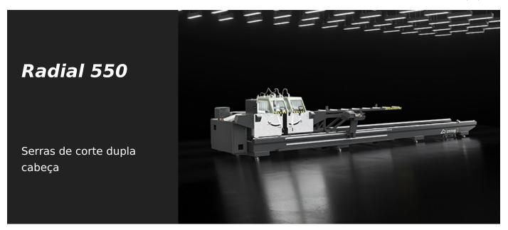
Máquina de corte de cabeça dupla eletrónica com movimento radial das lâminas, deslocamento automático da cabeça móvel em patins de esferas recirculantes através de sistema de pinhão e cremalheira; inclinação interna de até 30°, projetada para o corte de perfis de grandes dimensões. O avanço da lâmina é acionado por um par de cilindros óleopneumáticos.
