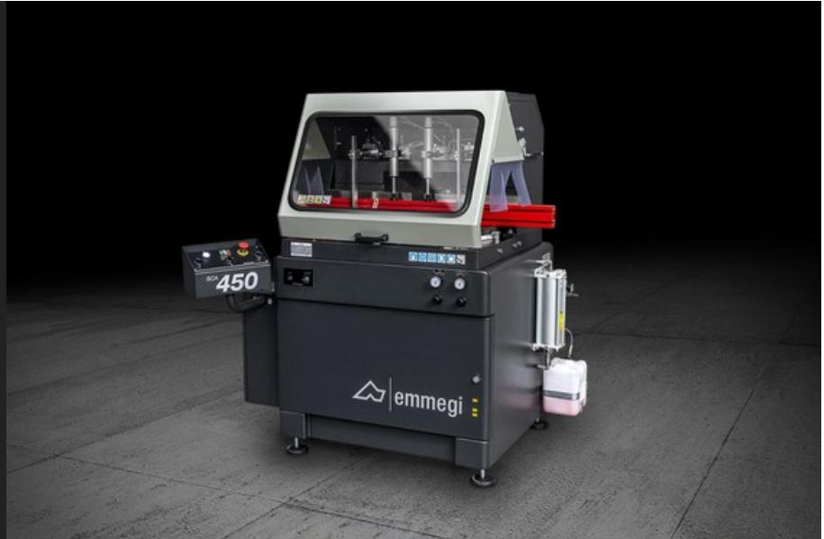
Máquina de corte monocabeça ascendente, com lado de carga à esquerda, para ângulos de corte de 20° à esquerda a 20° à direita e ângulos intermediários.
