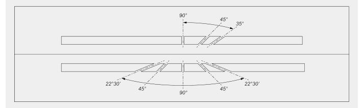
Regulação eletrónica dos ângulos intermediários no eixo vertical Regulação mecânica dos ângulos intermediários no eixo horizontal
