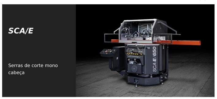
Máquina de corte monocabeça ascendente com rotação automática, por CN, do eixo vertical mediante motor Brushless e simultâneo basculamento, por comando hidráulico, do eixo horizontal. Cortes com ângulos de 90° a 22°30′ (à esquerda e à direita) sobre o eixo vertical e de 90° a 35° (somente à direita) sobre o eixo horizontal.
