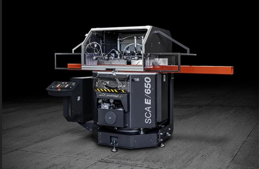
Máquina de corte monocabeça ascendente com rotação automática, por CN, do eixo vertical mediante motor Brushless e simultâneo basculamento, por comando hidráulico, do eixo horizontal. Cortes com ângulos de 90° a 22°30' (à esquerda e à direita) sobre o eixo vertical e de 90° a 35° (somente à direita) sobre o eixo horizontal.
