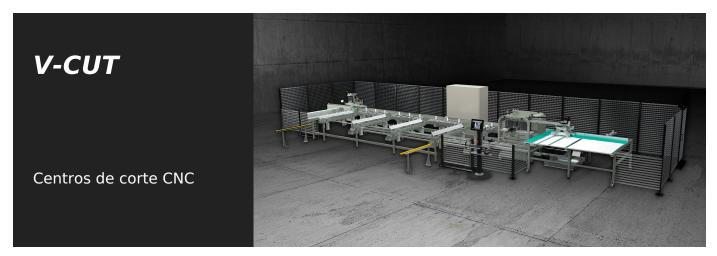
Centro de corte com CNC de 3 eixos controlados, dedicado ao corte de perfis de alumínio, PVC, ligas leves em geral. V-CUT, partindo da barra de perfil extrudido, carrega, corta e descarrega automaticamente listas de corte predefinidas e optimizadas. Previsto para efetuar cortes com ângulos de 45° a 135° ou de 22°30′ a 157°30′.
