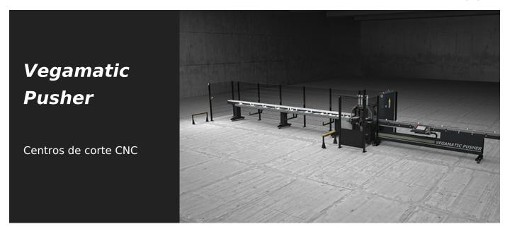
Centro de corte em versão semiautomática com 2 eixos controlados, carga/descarga manual em lados opostos da máquina, com disco de corte frontal em CNC específico para o corte de perfis em alumínio, PVC e ligas leves em geral. Efetua automaticamente as listas de corte predefinidas e otimizadas. Previsto para efetuar cortes com ângulos de 45° a 135° ou de 22°30′ a 157°30′. Configurável com unidade de perfuração horizontal ou vertical personalizável para usinagens automáticas específicas.
