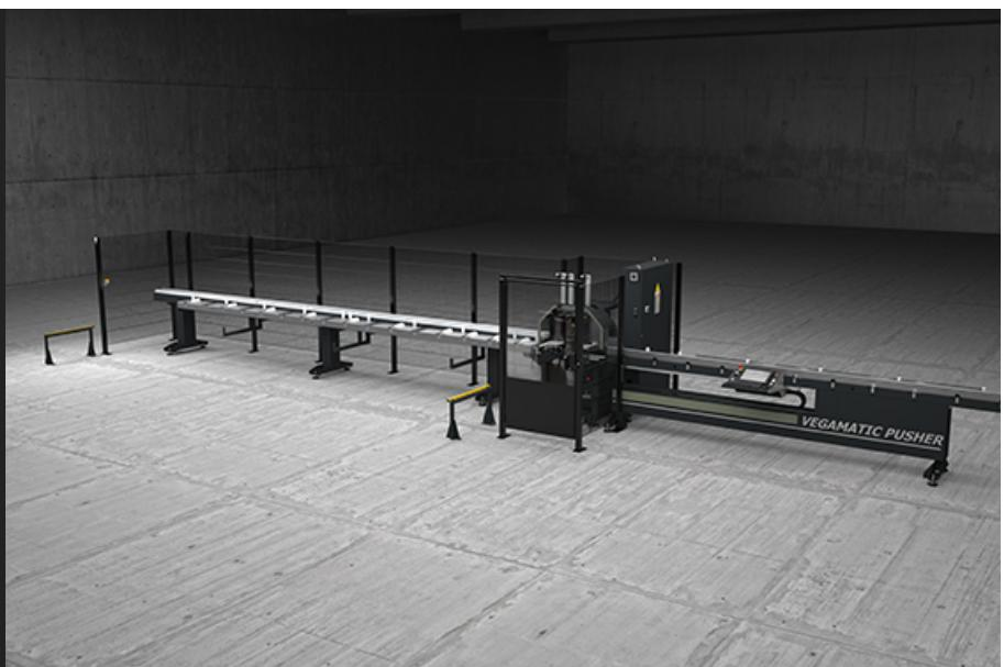
Centro de corte em versão semiautomática com 2 eixos controlados, carga/descarga manual em lados opostos da máquina, com disco de corte frontal em CNC específico para o corte de perfis em alumínio, PVC e ligas leves em geral. Efetua automaticamente as listas de corte predefinidas e otimizadas. Previsto para efetuar cortes com ângulos de 45° a 135° ou de 22°30' a 157°30'. Configurável com unidade de perfuração horizontal ou vertical personalizável para usinagens automáticas específicas.
