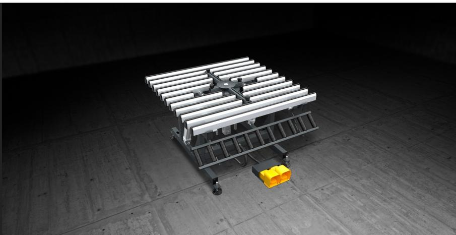
Стол для сборки остекленных створок, имеющий наклонную рабочую поверхность под углом от 0° (горизонтальное положение) до 85°. Выдвижной рольганг регулируется по высоте (в диапазоне от 170 до 460 мм), независимо от рабочей поверхности стола. Поверхность рабочего стола регулируется от 895 до 965 мм, а опорные ножки располагают отверстиями для крепления к полу. Стол оборудован центральной крестовиной для подъема и позиционирования стекла.
