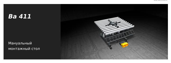
Стол для сборки остекленных створок, имеющий наклонную рабочую поверхность под углом от 0° (горизонтальное положение) до 85°. Выдвижной рольганг регулируется по высоте (в диапазоне от 170 до 460 мм), независимо от рабочей поверхности стола. Поверхность рабочего стола регулируется от 895 до 965 мм, а опорные ножки располагают отверстиями для крепления к полу. Стол оборудован центральной крестовиной для подъема и позиционирования стекла.
