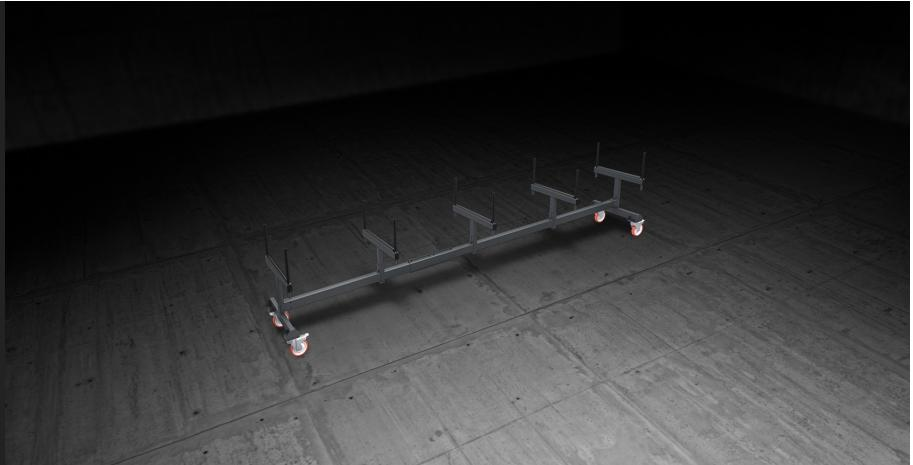
Каретка больших размеров, разработанная для транспортировки и складирования профиля на этапе резки.
