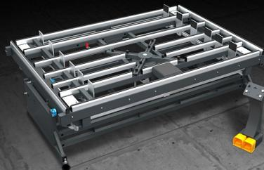
Стол предназначенный для установки на алюминиевую раму прокладок и остекления. С помощью крестовины стекло приподнимается и, благодаря системе самовыравнивающих прижимов, рамы прессуются друг к другу. После прессовки первых двух сторон крестовина поворачивается, так чтобы можно было опрессовать другие две стороны.
