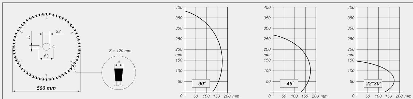
НАКЛОН РЕЖУЩЕГО УЗЛА
