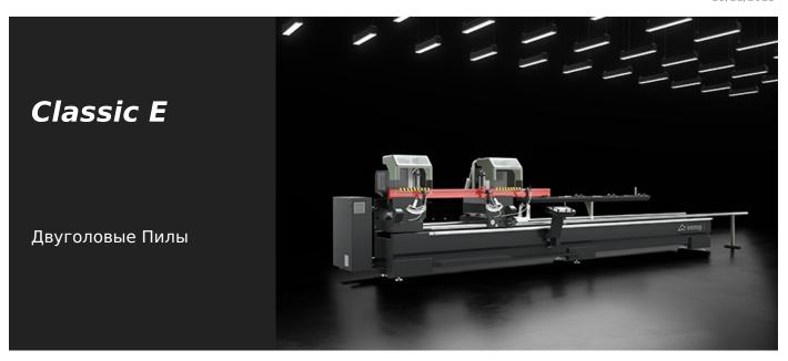
Электронный двухголовочный отрезной станок с подвижной головкой, автоматически приводимой в действие вентильным двигателем, управляемым ЧПУ. Пневматический наклон режущих блоков в 3 фиксированных положениях 90°, 45° и 22°30′ (внешний) или используя механическую систему ручной регулировки для установки промежуточных углов. Гидравлическая подача режущего диска.
