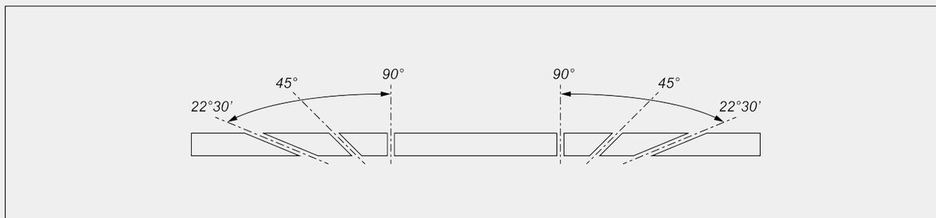
Механическая регулировка промежуточных углов наклона
