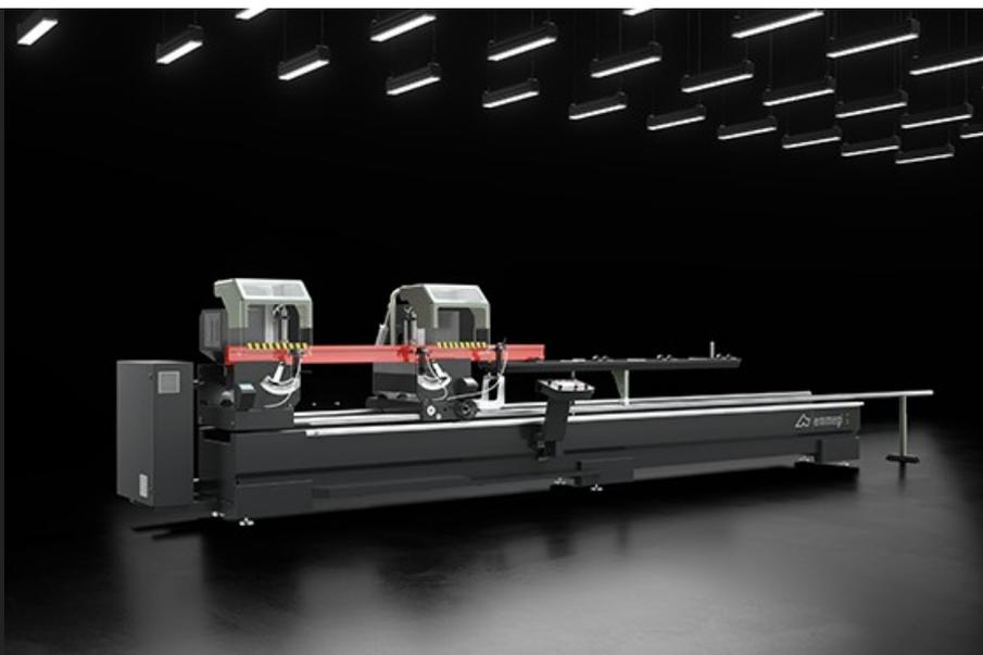
Электронный двухголовочный отрезной станок с подвижной головкой, автоматически приводимой в действие вентильным двигателем, управляемым ЧПУ. Пневматический наклон режущих блоков в 3 фиксированных положениях 90°, 45° и 22°30' (внешний) или используя механическую систему ручной регулировки для установки промежуточных углов. Гидравлическая подача режущего диска.
