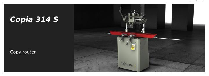
Одноголовочный пантограф с ручным приводом с большим ходом по высоте и перемещением головки с помощью рукоятки или непрямого рычага. Возможность сквозной обработки без поворота заготовки. Щуп с ручным управлением.
