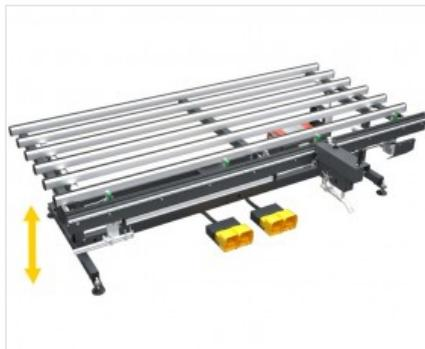
**Пневматический наклон рабочей поверхности**
