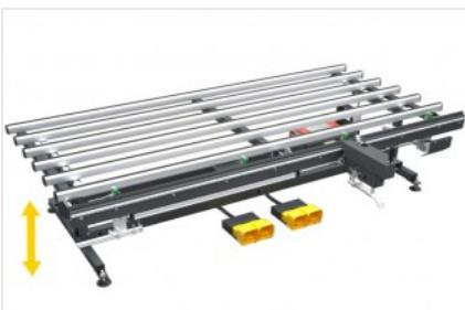
**Пневматический наклон рабочей поверхности**
