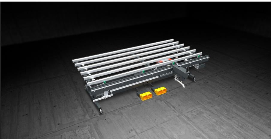
Стол для монтажа внешней ленточной фурнитуры на створки из алюминия, дерева и ПВХ. Система выдвижных зажимов обеспечивает блокировку створки. Стол оборудован системой завинчивания с автоматической подачей, а также, в качестве дополнительной принадлежности, системой измерения и резки фурнитуры гидравлическими ножницами.
