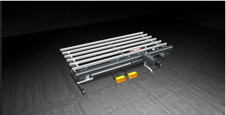
Стол для монтажа внешней ленточной фурнитуры на створки из алюминия, дерева и ПВХ. Система выдвижных зажимов обеспечивает блокировку створки. Стол оборудован системой завинчивания с автоматической подачей, а также, в качестве дополнительной принадлежности, системой измерения и резки фурнитуры гидравлическими ножницами.
