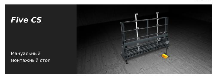
Испытательный стенд для алюминиевых переплетных конструкций. Он позволяет воссоздать условия эксплуатации переплетных конструкций: рама блокируется с помощью системы зажимов, регулируемых по всей высоте рамного переплета, внутрь рамы вставляются створки, стекла и производится окончательное испытание. Рольганг позволяет оператору загружать и разгружать тяжелые модули в режиме полной автономии.
