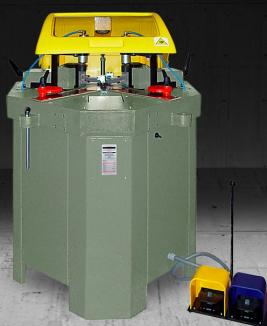
Чеканочный станок для закрытия углов алюминиевых профилей всех типов. Легко регулируется благодаря перемещению пуансонов. Ножевые блоки оснащены быстросъемным креплением и магнитами для предотвращения их падения. Простота в использовании и универсальность.
