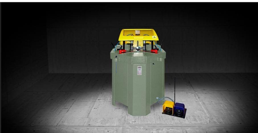
Чеканочный станок для закрытия углов алюминиевых профилей всех типов. Легко регулируется благодаря перемещению пуансонов. Ножевые блоки оснащены быстросъемным креплением и магнитами для предотвращения их падения. Простота в использовании и универсальность.
