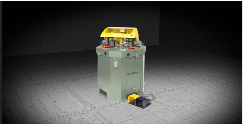
Чеканочный станок для закрытия углов алюминиевых профилей для дверей, окон и фасадов. Легко регулируется благодаря перемещению пуансонов. Ножевые блоки оснащены быстросъемным креплением и магнитами для предотвращения их падения. Оснащен цифровым устройством считывания показателя смещения чеканочных головок и опорной вилки профиля. Регулировка упрощается благодаря легко читаемому дисплею.
