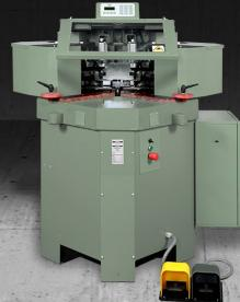
Станок оснащен двумя специальными рабочими головками, оборудованными массами, в которых 2 ножа регулируются во всех положениях снятия фасок. Ножи перемещаются и регулируются по оси Y (вдоль профиля), по оси Z (вверх-вниз) и по оси X (по направлению снятия фасок). Эти условия позволяют избежать смены инструментов на станке независимо от различных типов профиля. Таким образом сокращается время и расходы на переналадку.
