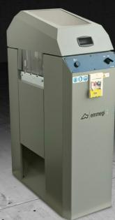
Горизонтальный торцовочный станок с ручной подачей. Фрезерование под углом 90°. Быстрая смена фрезеровочного узла с помощью рычажного управления. Рабочий стол с защитой от царапин. Встроенное защитное ограждение рабочей зоны.
