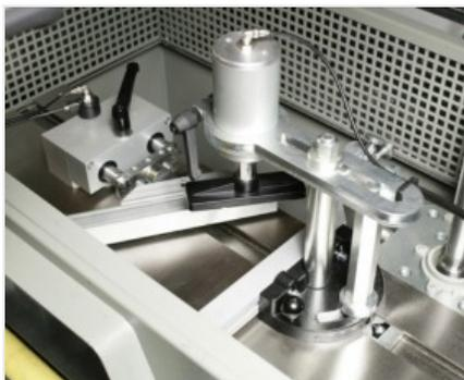
**Зажимной узел и положение вне прямоугольной опоры**
