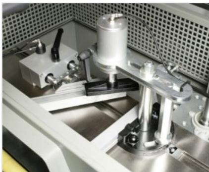
**Зажимной узел и положение вне прямоугольной опоры**
