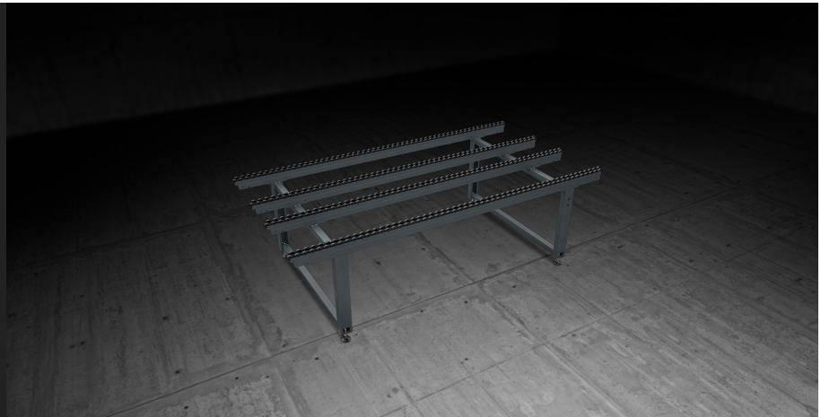
Роликовый конвейер, обеспечивающий соединение между местами сборки и легкую транспортировку рам, в том числе тяжелых.
