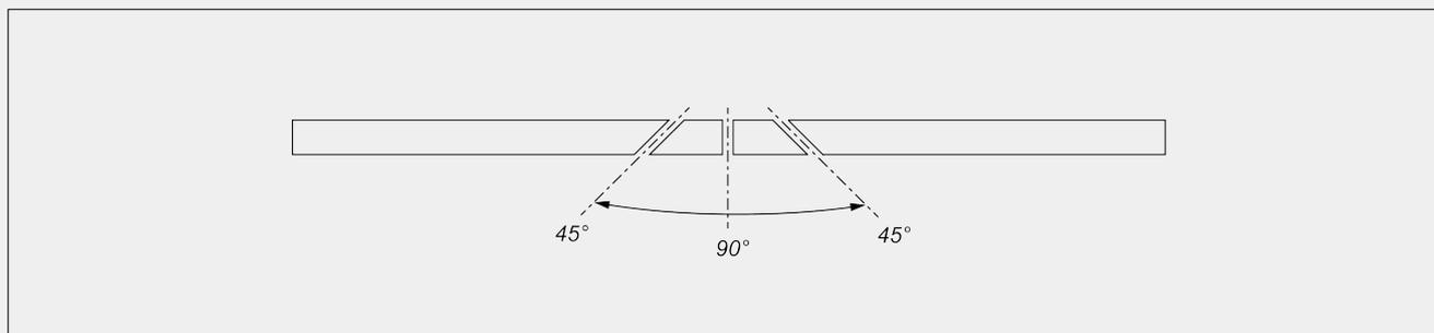
Механическая регулировка промежуточных углов наклона
