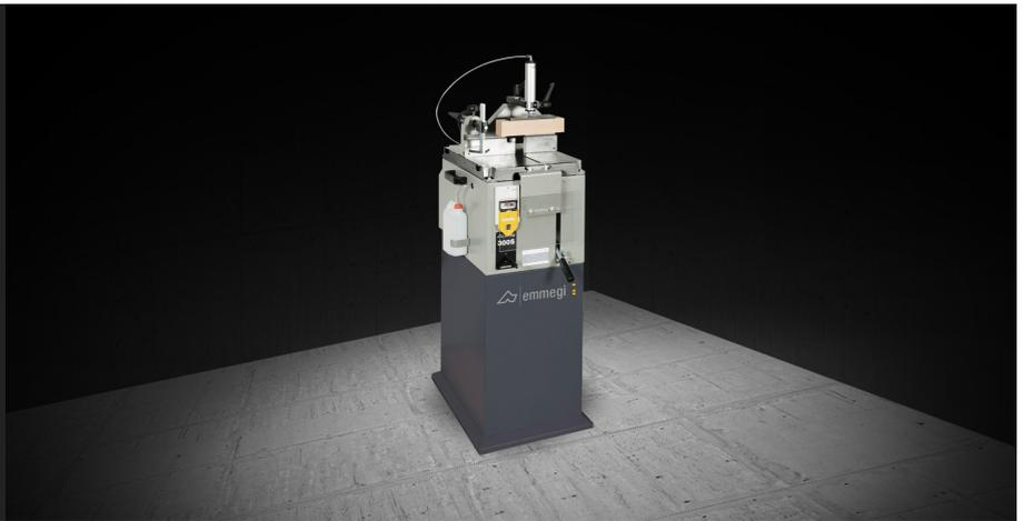
Одноголовочный отрезной станок с подъемным режущим диском для резки под углами 90°, 45° вправо и влево, а также для промежуточных углов.
