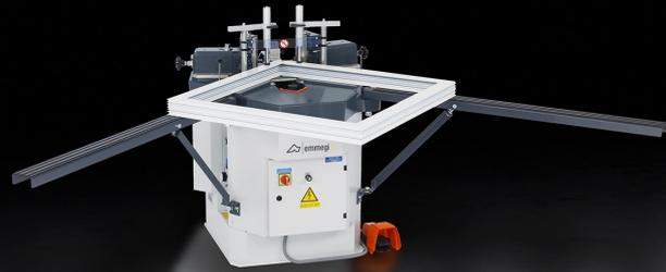
Пневматический станок для снятия фасок для прессования крупных профилей и структурированных фасадов с высокими требованиями к качеству. Его основными преимуществами являются: простота конфигурации и использования, минимальное время оснащения и регулировки; исключительная прочность конструкции, обеспечивающая высокую точность обработки; большое усилие прессования обеспечивается за счет объемного сальфонного цилиндра, не требующего технического обслуживания.
