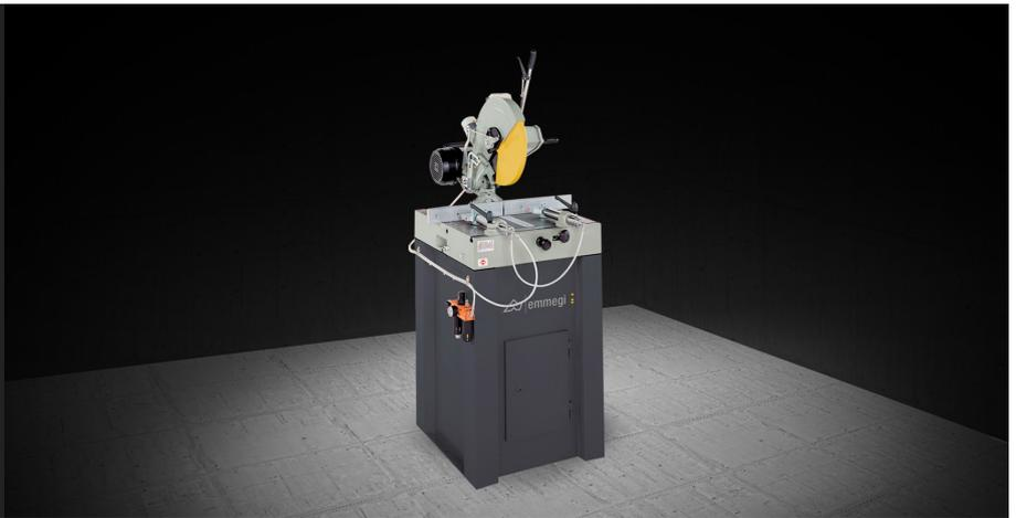
Одноголовочный отрезной станок с опускающимся режущим диском, загрузкой слева, вращением режущего узла на 45° (влево и вправо) и ручным наклоном на 45° относительно горизонтальной оси.
