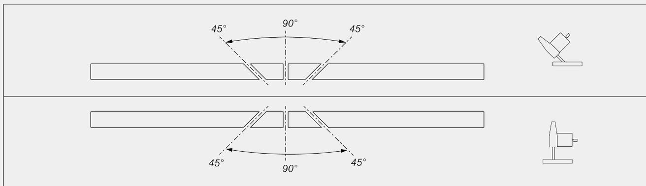
Механическая регулировка промежуточных углов наклона
