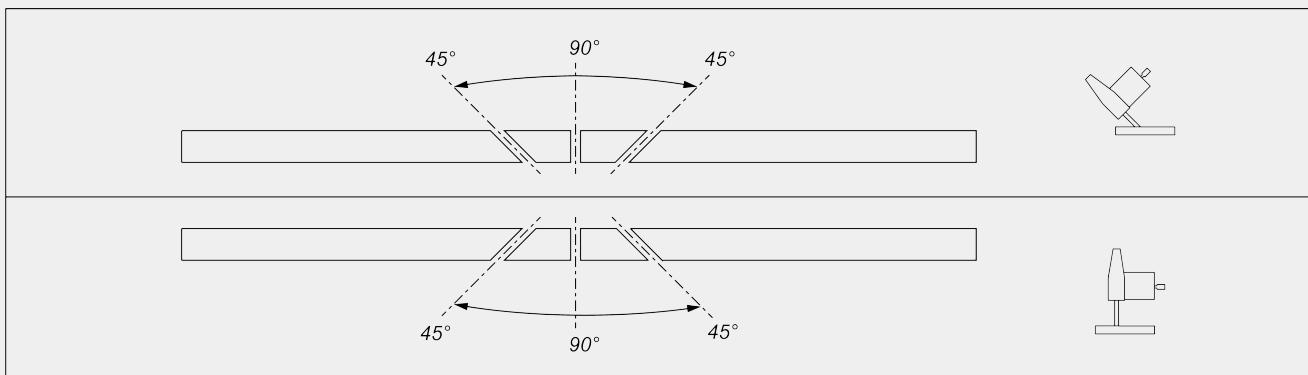
Механическая регулировка промежуточных углов наклона
