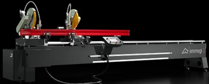
Двухголовочный пильный станок с ручным перемещением подвижной головки и определением положения с помощью абсолютной магнитной ленты. Вращение режущих блоков по вертикальной оси (45° влево и вправо) и наклон по горизонтальной оси (45° внутрь) с ручной регулировкой позволяют выполнять комбинированные распилы даже под промежуточными углами.
