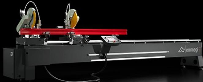
Двухголовочный пильный станок с ручным перемещением подвижной головки и определением положения с помощью абсолютной магнитной ленты. Вращение режущих блоков по вертикальной оси ( $45^\circ$  влево и вправо) и наклон по горизонтальной оси ( $45^\circ$  внутрь) с ручной регулировкой позволяют выполнять комбинированные распилы даже под промежуточными углами.
