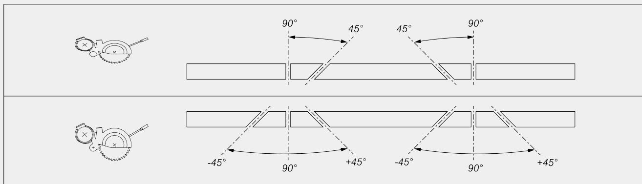
Механическая регулировка промежуточных углов наклона
