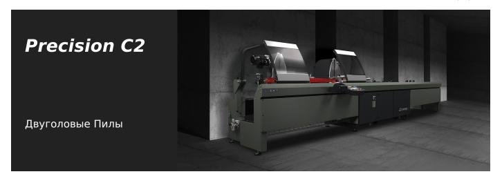
Электронный двухголовочный отрезной станок с автоматическим перемещением подвижной головки с помощью бесщеточного двигателя, управляемого числовым программным управлением. Пневматический наклон режущих узлов от 90° до 22°30' (наружу) с механической системой регулировки промежуточных углов. Гидравлическая подача режущего диска.
