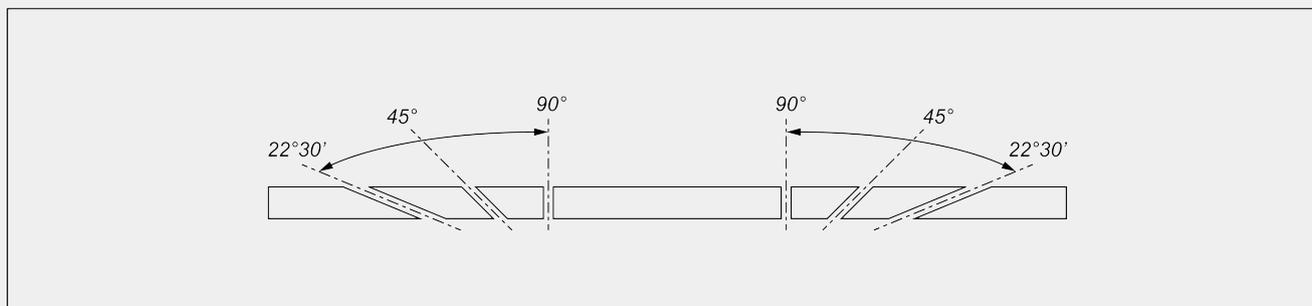
Механическая регулировка промежуточных углов наклона
