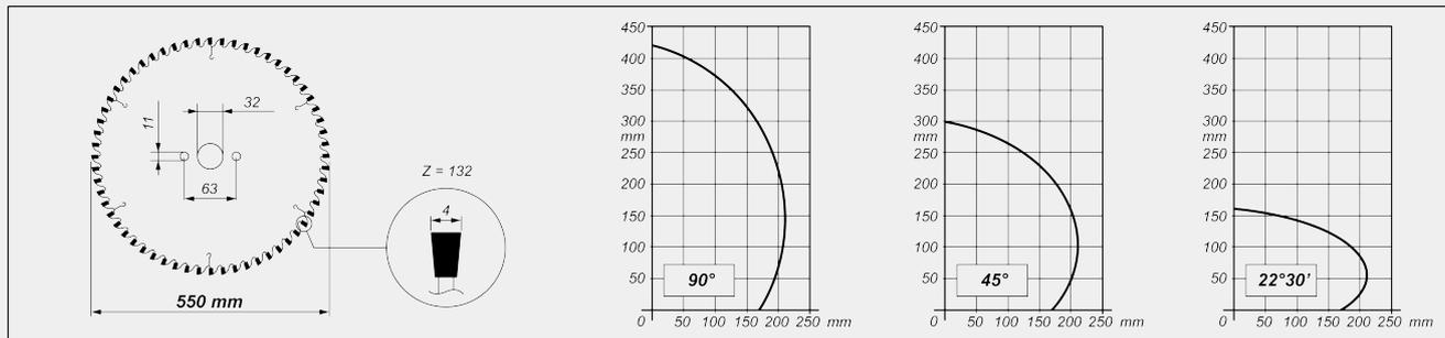
**НАКЛОН РЕЖУЩЕГО УЗЛА**
