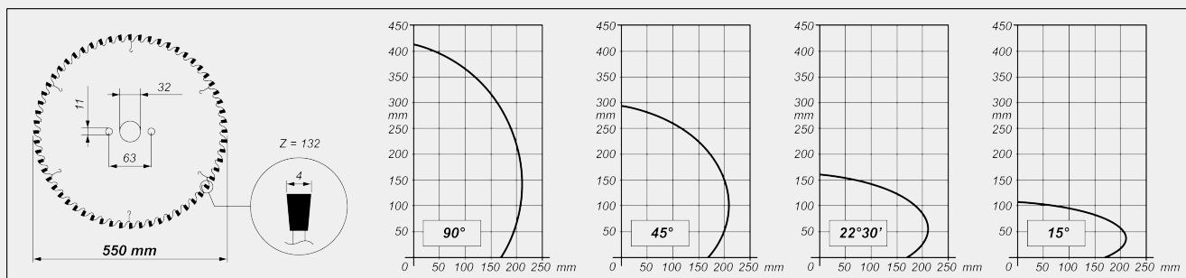
**НАКЛОН РЕЖУЩЕГО УЗЛА**
