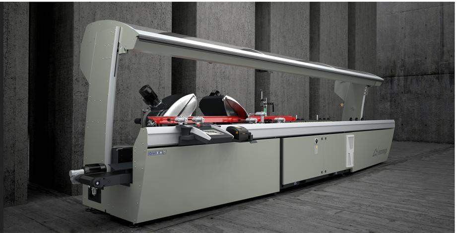
Двухголовочный отрезной станок с 5 управляемыми осями для алюминия, ПВХ и легких сплавов, с автоматическим перемещением подвижной головки и электронным управлением всеми углами от 45° (внутренний) до 15° (внешний) с точностью, в пределах каждого градуса, до 280 позиций. Подача режущих дисков в базовой комплектации приводится в действие парой гидравлических цилиндров. Режущий диск диаметром 550 мм. Доступен для резки полезной длины в размере 5 или 6 м.
