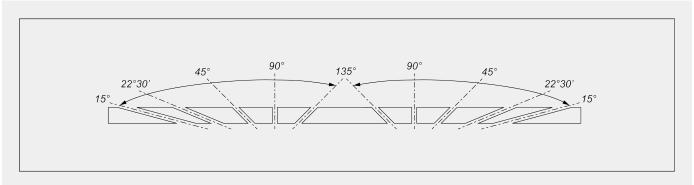
Электронная регулировка промежуточных углов наклона
