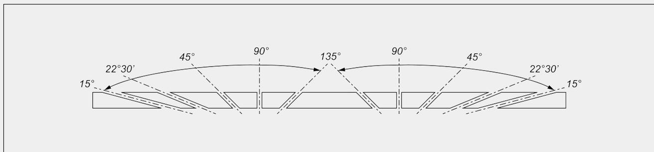
Электронная регулировка промежуточных углов наклона
