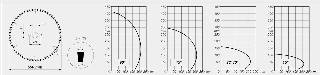
**НАКЛОН РЕЖУЩЕГО УЗЛА**
