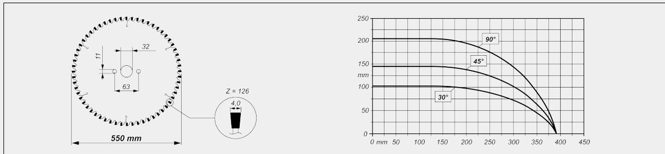
**НАКЛОН РЕЖУЩЕГО УЗЛА**
