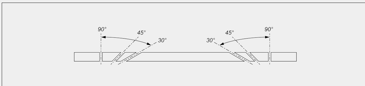
Электронная регулировка промежуточных углов наклона
