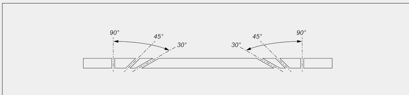
Электронная регулировка промежуточных углов наклона
