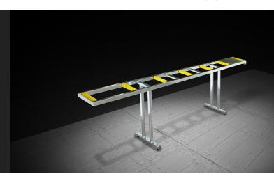
Стальная конструкция из трубчатых профилей с регулируемыми по высоте ножками: с роликами шириной 240 мм длина рольганга составляет 3.500 мм; с роликами шириной 440 мм длина рольганга составляет 4.000 мм.
