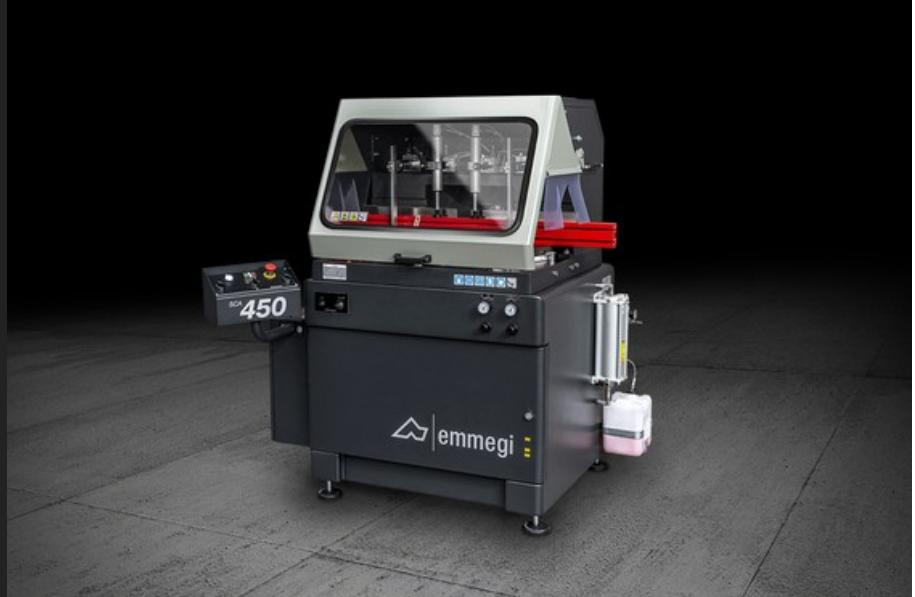
Отрезной станок с одной подъемной головкой с загрузкой с левой стороны для резки под углами от 20° влево до 20° вправо и промежуточных углов.
