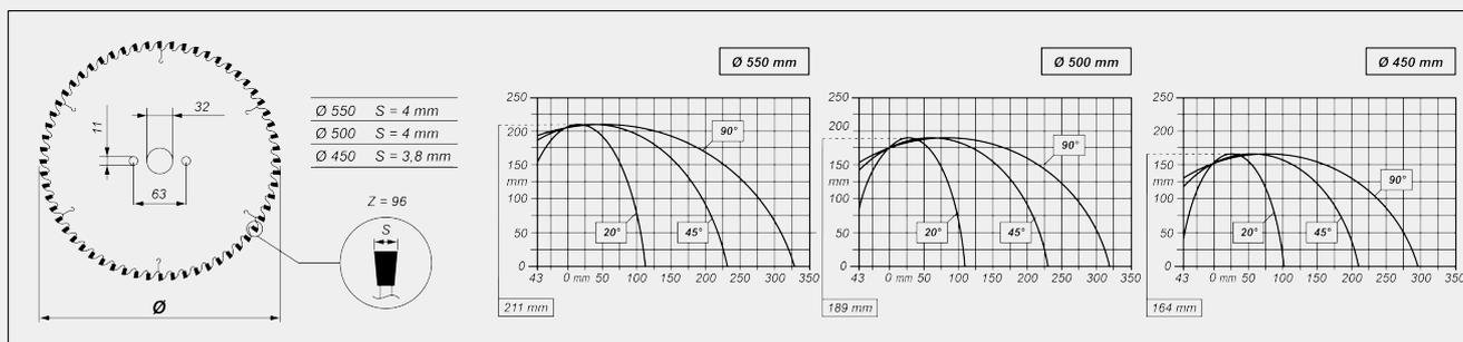
НАКЛОН РЕЖУЩЕГО УЗЛА
