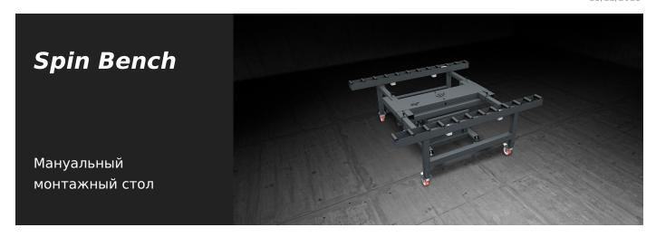
Модульный стол предназначен для сборки и перемещения на линии секций фасада. Он оборудован двумя роликовыми конвейерами, покрытыми мягким ПВХ; расстояние между двумя роликовыми дорожками регулируется в зависимости от ширины переплета. Пневматическая система позволяет блокировать ролики при выполнении этапов технологического процесса. Весь стол может поворачиваться на 360° с целью упрощения операций сборки и герметизации секции; наклонное положение удерживается пневматическим управлением.
