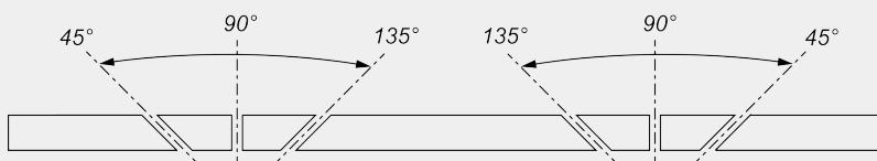
Электронная регулировка промежуточных углов наклона
