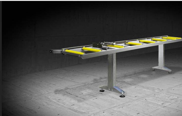
Стальная конструкция из трубчатых профилей с регулируемыми по высоте ножками и роликами, покрытыми ПВХ. С роликами шириной 240 мм длина рольганга составляет 3.500 мм; с роликами шириной 440 мм длина рольганга составляет 4.000 мм.
