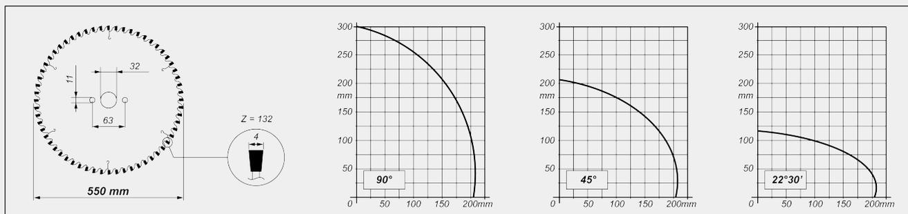
**НАКЛОН РЕЖУЩЕГО УЗЛА**
