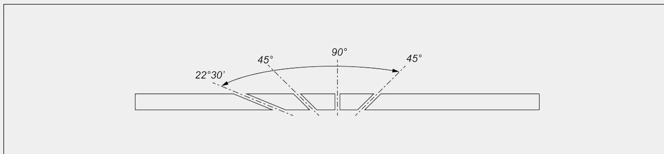
Механическая регулировка промежуточных углов наклона
