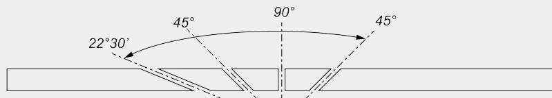
Механическая регулировка промежуточных углов наклона
