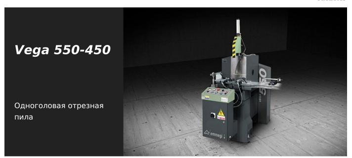
Одноголовочный отрезной станок с фронтальным режущим диском, загрузкой слева и двойным опрокидыванием с боковой стороны с пневматическим управлением в фиксированных положениях: 45° влево и 90°, 45° и 22°30' вправо. Специальный механический упор позволяет также выполнять резку под промежуточными углами.
