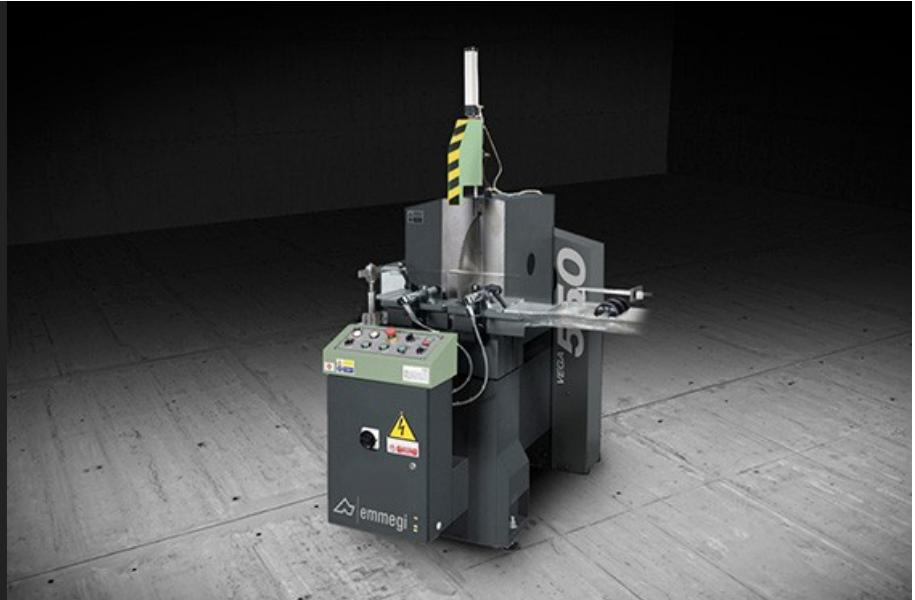
Одноголовочный отрезной станок с фронтальным режущим диском, загрузкой слева и двойным опрокидыванием с боковой стороны с пневматическим управлением в фиксированных положениях: 45° влево и 90°, 45° и 22°30' вправо. Специальный механический упор позволяет также выполнять резку под промежуточными углами.
