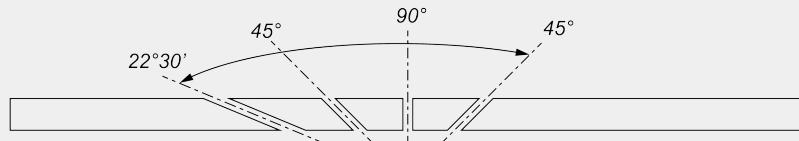
Механическая регулировка промежуточных углов наклона
