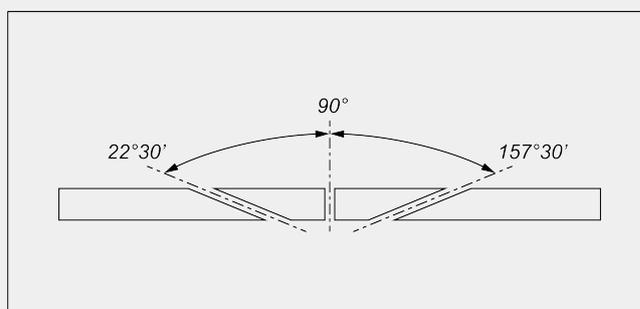
Электронная регулировка промежуточных углов наклона
