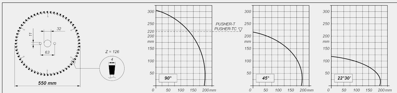
НАКЛОН РЕЖУЩЕГО УЗЛА
