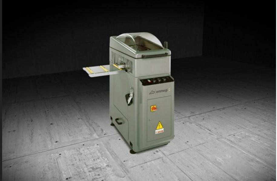
Elektro pnömatik ilerlemeli yatay doğrama ünitesi.  $+45^\circ$  /  $90^\circ$  /  $-45^\circ$  gönye dışı frezeleme. Boyalı ve gönye dışı profil üzerindeki işleme kalitesini iyileştirmek için yüksek takım dönme hızı. Pnömatik idareli freze grubunu hızlı değiştirme. Çizilmez çalışma düzlemi. Entegre, geniş iç görüş açılılı çalışma alanı.
