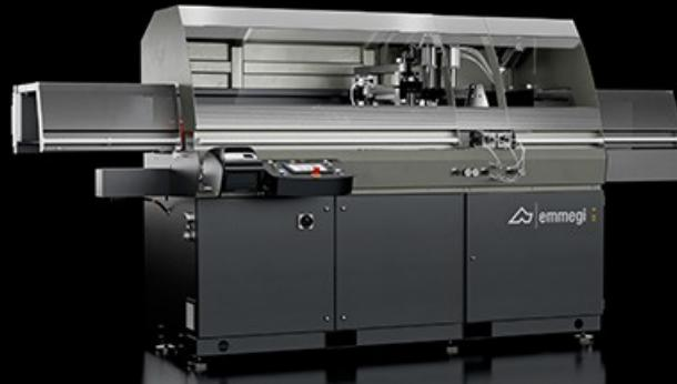
用于 90° 切割的自动循环上升式单头切割机配备了数控电动棒材进给系统。可以配置四个不同直径的刀片和通过数控系统控制的电动刀片进给装置。机床可以配置使用两种不同直径的刀片。只需进行简单的装备操作、软件就可以根据所安装的刀片自动进行正确设置。对于要求完美切面的切割需求、可选配一个气动系统、用于自动分离切割件、以避免在使用此切割模式的机床中出现通常会因刀片返回而留下的痕迹。另外、还可配置变频器、以改变刀片旋转速度、使其以最佳的方式适应待切割型材。可以配备大容量自动棒材装载库；带传送带（用于提取经过切割的工件）和积料台的卸料库；可以根据具体需求进行定制的钻孔和铣削单元。由于配件种类繁多、因此可以将这台机床配置成一个真正的全自动切割中心。另外、还可以增加定制的特定工作单元来进行钻孔和铣削加工。
