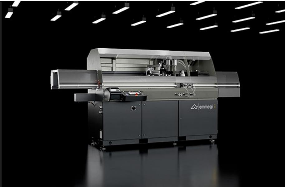
用于 90° 切割的自动循环上升式单头切割机配备了数控电动棒材进给系统。可以配置四个不同直径的刀片和通过数控系统控制的电动刀片进给装置。机床可以配置使用两种不同直径的刀片。只需进行简单的装备操作、软件就可以根据所安装的刀片自动进行正确设置。对于要求完美切面的切割需求、可选配一个气动系统、用于自动分离切割件、以避免在使用此切割模式的机床中出现通常会因刀片返回而留下的痕迹。另外、还可配置变频器、以改变刀片旋转速度、使其以最佳的方式适应待切割型材。可以配备大容量自动棒材装载库；带传送带（用于提取经过切割的工件）和积料台的卸料库；可以根据具体需求进行定制的钻孔和铣削单元。由于配件种类繁多、因此可以将这台机床配置成一个真正的全自动切割中心。另外、还可以增加定制的特定工作单元来进行钻孔和铣削加工。
